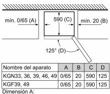
en modelos con tirador vertical integrado, se requiere una distancia mínima
